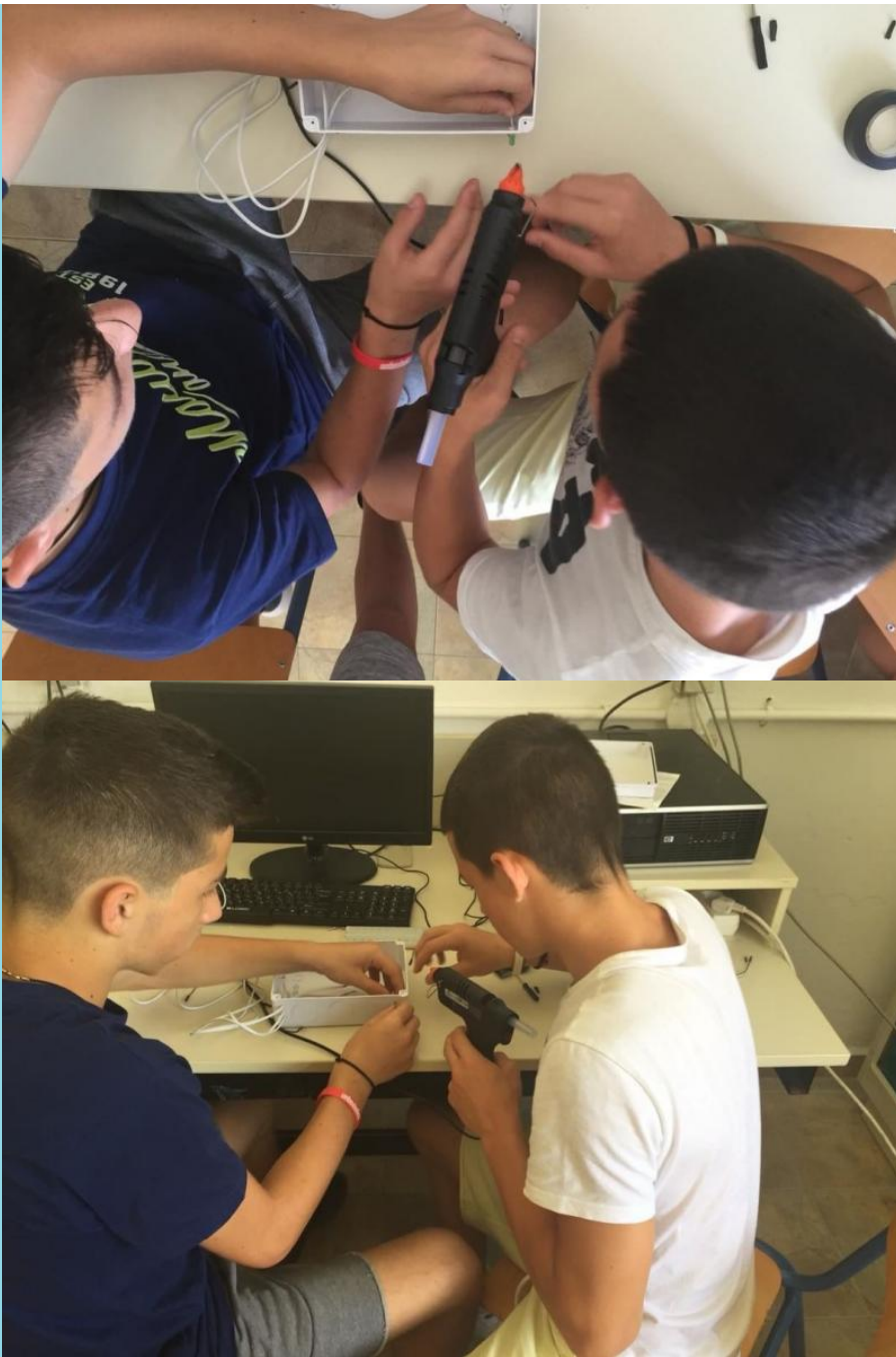
3) Συνδέουμε τα καλώδια και τα λαμπάκια μαζί με τις αντιστάσεις τους στο breadboard.
